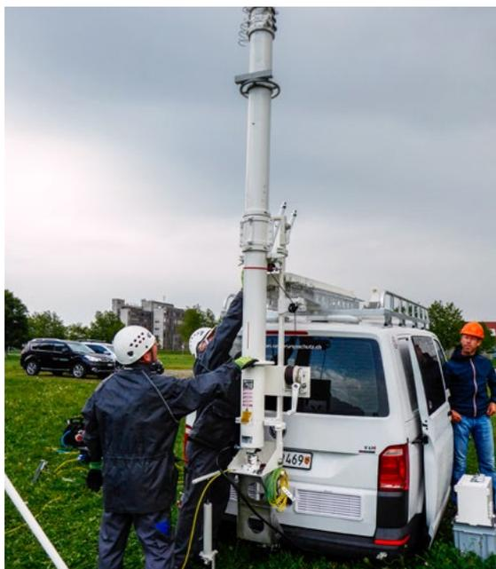
Des tests l'ont confirmé: le dispositif de fixation des mâts d'antenne hydrauliques télescopiques d'une hauteur de 15 mètres, l'alimentation électrique et la climatisation fonctionnent parfaitement.
